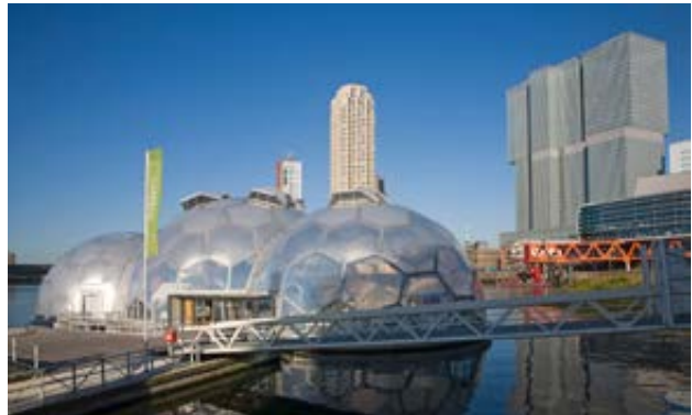
Floating Pavilion, Rotterdam, Nederländerna. Kupolernas skelett av stål är klädda med ETFE-folie (ethylene tetra fluoro ethylene). Pontoner av EPS (expanderad polystyren). Skapade inom ett lokalt hållbarhetsprojekt. Design/arkitektur: Deltasync/Allmänhet Foto: Ian Murray
